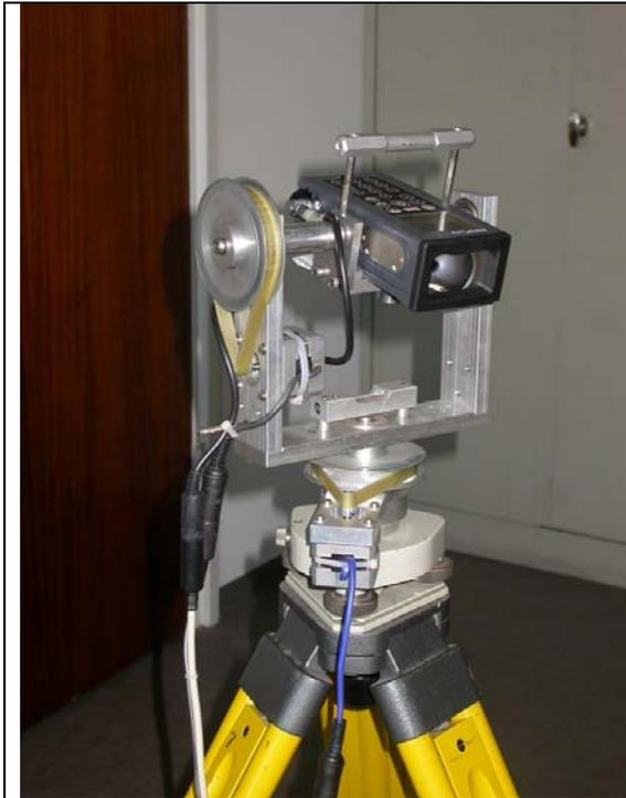
**Abb. 3:** Prototype Laserscanner
